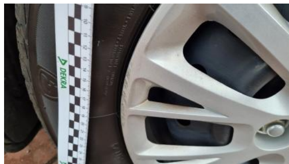
Fot. 26 Kołpak przedni prawy (Rysa/Odprysk)
