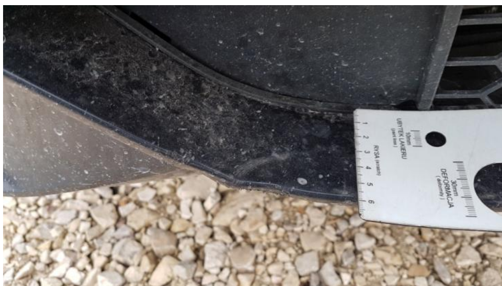
Fot. 27. Zderzak P - wgniecenie/odkształcenie
