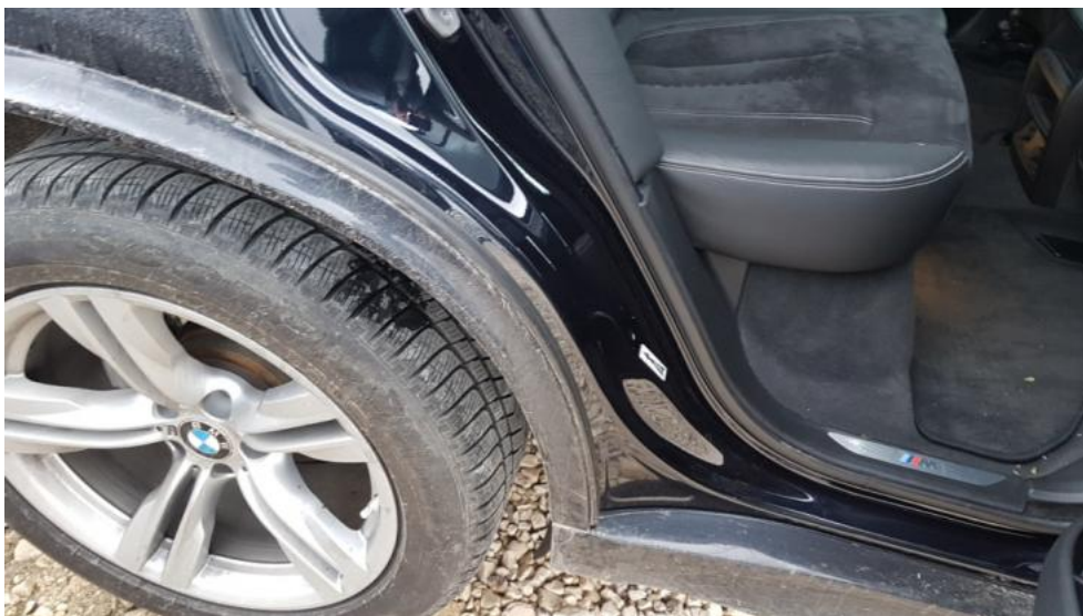
Fot. 31. Błotnik TP - wgniecenie/ubytek lakieru
