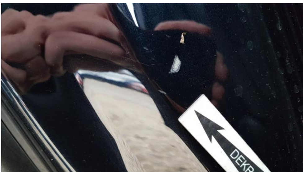
Fot. 32. Błotnik TP - wgniecenie/ubytek lakieru
