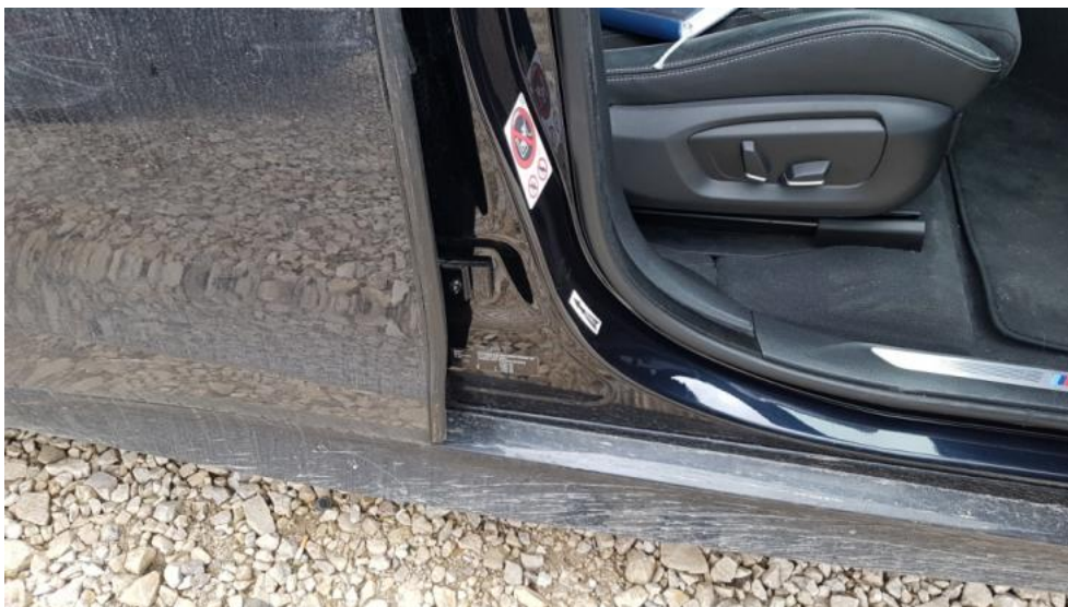
Fot. 33. Słupek śr.P - wgniecenie
