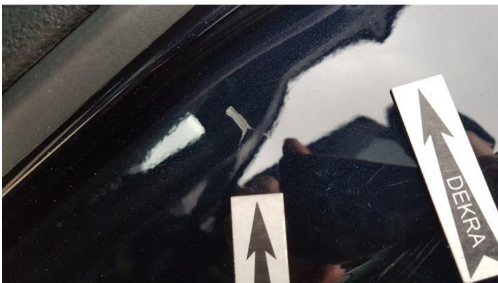
Fot. 30. Błotnik TL - wgniecenie/ubytek lakieru
