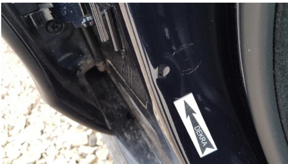
Fot. 34. Słupek śr.P - wgniecenie
